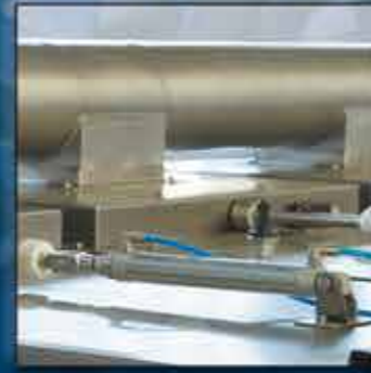
Pinömatik sistemle otomatik açılan dolum kapakları
