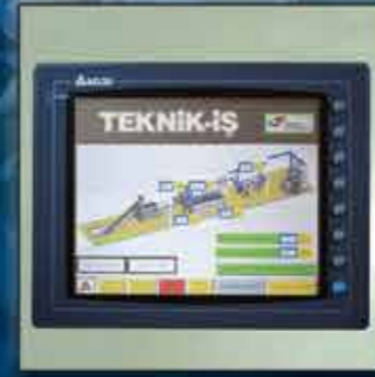
Bilgisayarlı PLC kontrollü, dokunmatik ekranlı ve animasyonlu elektronik kontrol panosu
