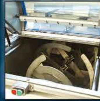
Dolu mil ve lamadan kaliteli malaksör karıştırıcısı
