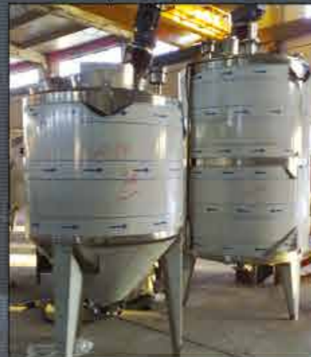
Karıştırıcı Isıtma Ceketli ve İzoleli Tanklar
