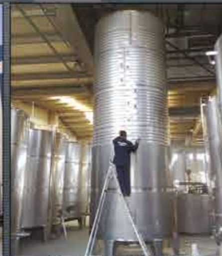
Isıtma Ceketli ve İzolasyonlu Tanklar
