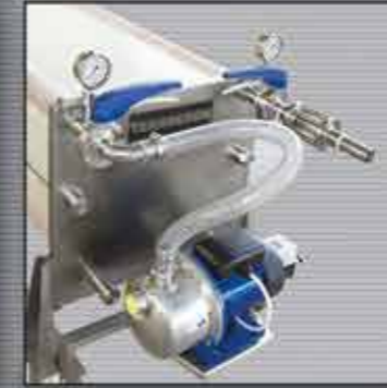
Filtre edilecek ürün cinsine göre seçilmiş özel besleme pompaları. Different kind of pumps choosed for each specific product.
